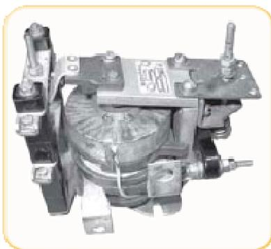
Реле РЭВ-311 применяются в качестве реле контроля напряжения с высоким коэффициентом возврата (не менее 0,7). Реле РЭВ-311 допускают регулировку на напряжение срабатывания в пределах 25-85% номинального напряжения катушки. Реле поставляются отрегулированными на напряжение втягивания, равное 25% номинального напряжения.
