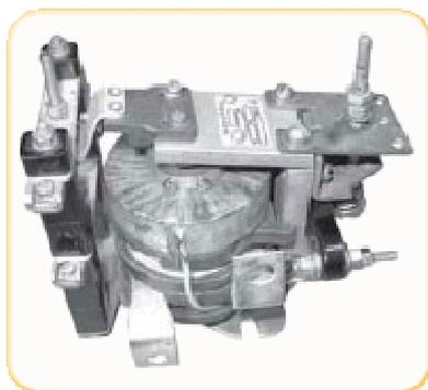
Реле РЭВ-312 применяются в качестве реле контроля тока с высоким коэффициентом возврата (не менее 0,7). Реле РЭВ-312 допускают регулировку на ток срабатывания в пределах 30-65% номинального тока катушки.
